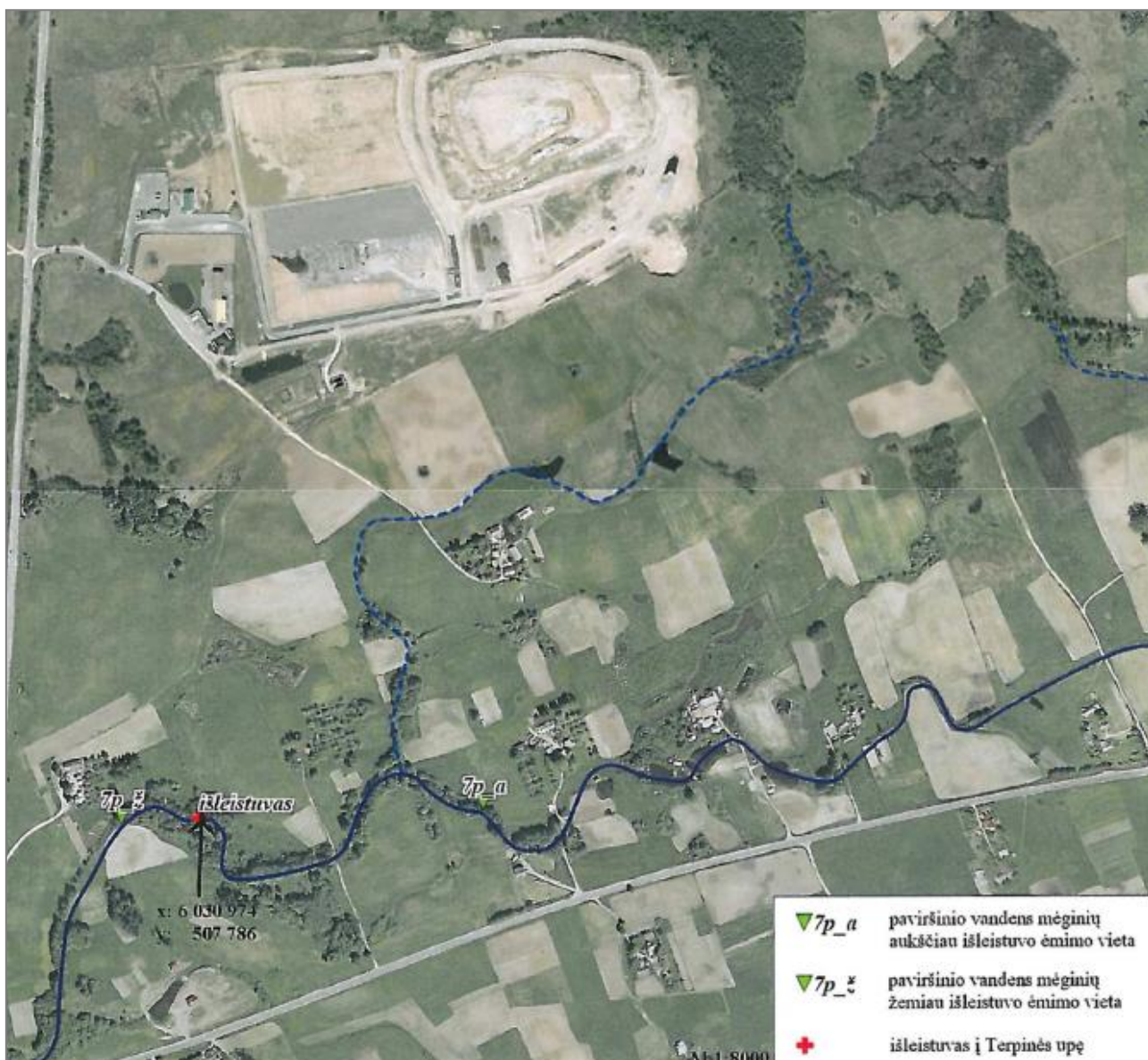
9 pav. Paviršinio vandens mėginių ėmimo schema (Alytaus regioninio sąvartyno, esančio Alytaus r. sav. Alovės sen., Takniškių k., Aplinkos monitoringo 2015 m. ataskaita)
